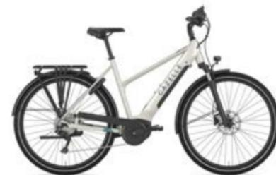
**SPÉCIFICATIONS** 10 vitesses Shimano Deore avec freins à disques hydrauliques Shimano BR-MT200 **POIDS (KG)** 24,0 (hors batterie) **COULEUR** mallard blue **DIAMANT** S(45) | M(50) | L(55) | XL(60) **COULEUR** ivory white **TRAPÈZE** S(45) | M(50) | L(55) | XL(60)
