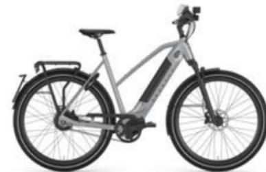
**SPÉCIFICATIONS** Enviolo Trekking avec freins à disques hydrauliques Magura MT4e **POIDS (KG)** 25,2 (hors batterie)
