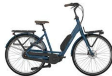
**SPÉCIFICATIONS** 7 vitesses Shimano Nexus avec freins à disques Magura MT-C4 **POIDS (KG)** 27,0 (hors batterie)
