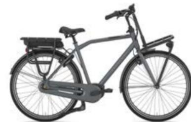
**SPÉCIFICATIONS** 7 vitesses Shimano Nexus avec freins hydrauliques Magura HS11 **POIDS (KG)** 25,6 (hors batterie)
