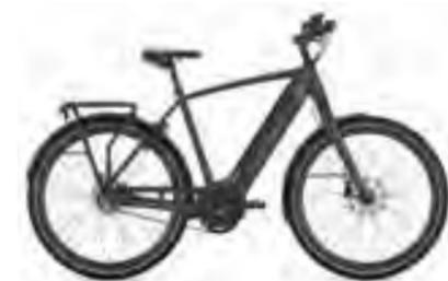
**DESCRIZIONE** Shimano Nexus a 8 rapporti con freni a disco idraulici Shimano BR-MT200 **PESO (KG)** 24,4 (batteria esclusa) **COLORE** champion red o orion blue opaco **PASSO BASSO** XS(46) | S(49) | M(53) | L(57) | XL(61) **COLORE** orion blue opaco **PASSO ALTO** M(53) | L(57) | XL(61) | XXL(65)
