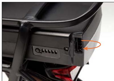
Ouvrir la trappe de protection du connecteur de chargement
