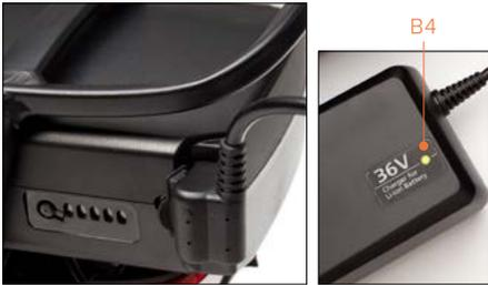
Vérification du bon déroulement de la mise en charge
