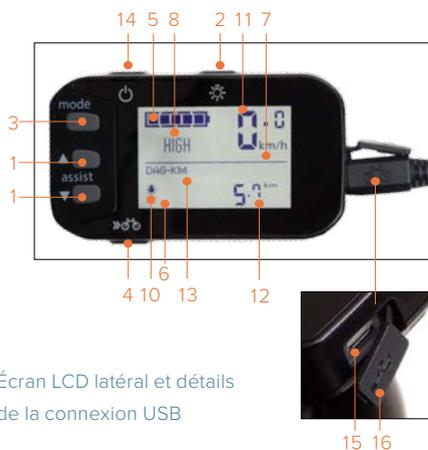
Écran LCD latéral et détails de la connexion USB
