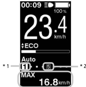
\*1 Gangstufe (nur bei elektronischer Gangschaltung angezeigt)
