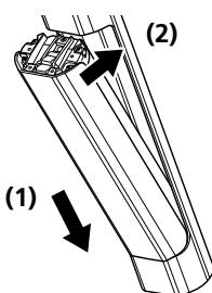
**2.1.6 Geïntegreerde accu uitnemen****1. Mocht er voor de accu nog een losse kunststof kap zitten, neem deze dan eerst uit de fiets.****2. Ontgrendel het accuslot.**
