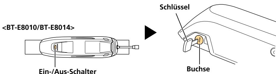
**2. Lösen Sie die Akku-Verriegelung.**
