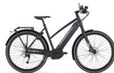
**SPÉCIFICATIONS** 10 vitesses Shimano Deore avec freins à disques hydrauliques Magura MT4e **POIDS DU VÉLO** 22,5 (hors batterie) **COULEUR** navy mat **FEMMES** 46|49|53|57 **COULEUR** navy mat **HOMMES** 53|57|61
