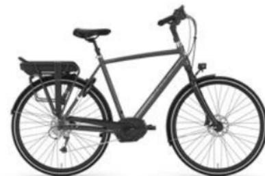
**SPÉCIFICATIONS** 10 vitesses Shimano Deore avec freins à disques Shimano SLX **POIDS DU VÉLO** 21,7 (hors batterie)
