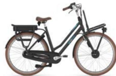
**SPÉCIFICATIONS** 7 vitesses Shimano Nexus avec rollerbrake à l'arrière et V-brakes à l'avant
