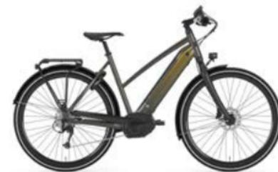
**SPÉCIFICATIONS** 10 vitesses Shimano Deore avec freins à disques hydrauliques Shimano BL-MT200 **POIDS DU VÉLO** 22 (hors batterie) **COULEUR** desert titanium grey mat **FEMMES** 46|49|53|57 **COULEUR** desert titanium grey mat **HOMMES** 53|57|61
