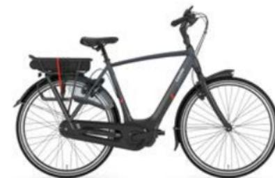
**SPÉCIFICATIONS** 8 vitesses Shimano Nexus Di2 avec freins hydrauliques Magura HS11 **POIDS DU VÉLO** 21,8 (hors batterie) **COULEUR** black mat / dust mat
